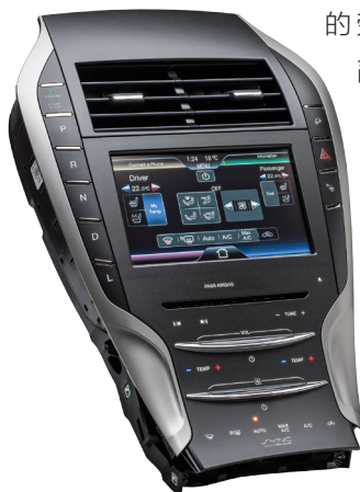
图 3 为实现对触摸箔的无气泡粘接，采用常压等离子对福特林肯 MKZ 汽车中控面板上的聚碳酸酯 (PC) 板进行预处理（图片来自 Preh）
