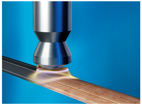
图5 等离子工艺可以对铝型材进行无铬预处理。附加的等离子聚合镀膜被用于汽车外部使用的型材上（图片来自Plasmatreat）
