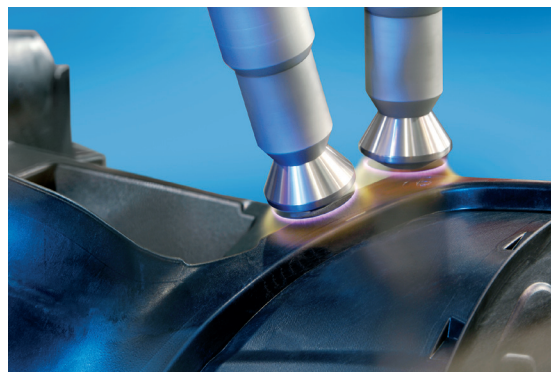
图4 机械手控制的等离子旋转喷枪可以实现区域选择性的处理。在发泡前通过扫描仪表板真实的轮廓形状，消除了遮蔽的需要（图片来自Plasmatreat）
