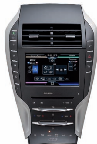
Abb. 1.: Das sogenannte Center Stack ist das Herzstück der Mittelkonsole und ein Funktionspackage auf engstem Raum. In seiner unteren Hälfte verbirgt sich eine sensitive Touchfolie mit der gedruckten Elektronik.
