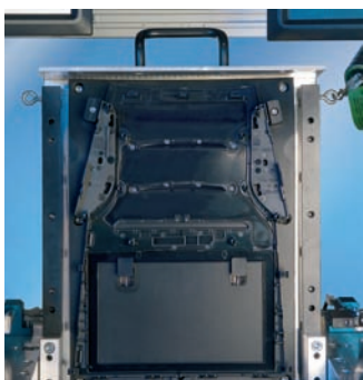
Abb. 3.: Unmittelbar nach der Plasmabehandlung wird die Polycarbonat-Blende in die Laminiervorrichtung eingelegt.
