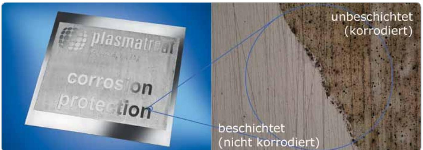
Bild 3: Die mikroskopische Aufnahme zeigt: der mit der PlasmaPlus Schicht geschützte Bereich zeigt auch nach Einwirkung von 96h Salzsprühnebel keine Anzeichen von Korrosion.
