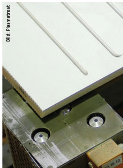
Klebstoffraupenauftrag: Auf einer Breite von mindestens 300 mm wird die Fläche mit Plasma mikrofein gereinigt und aktiviert.
