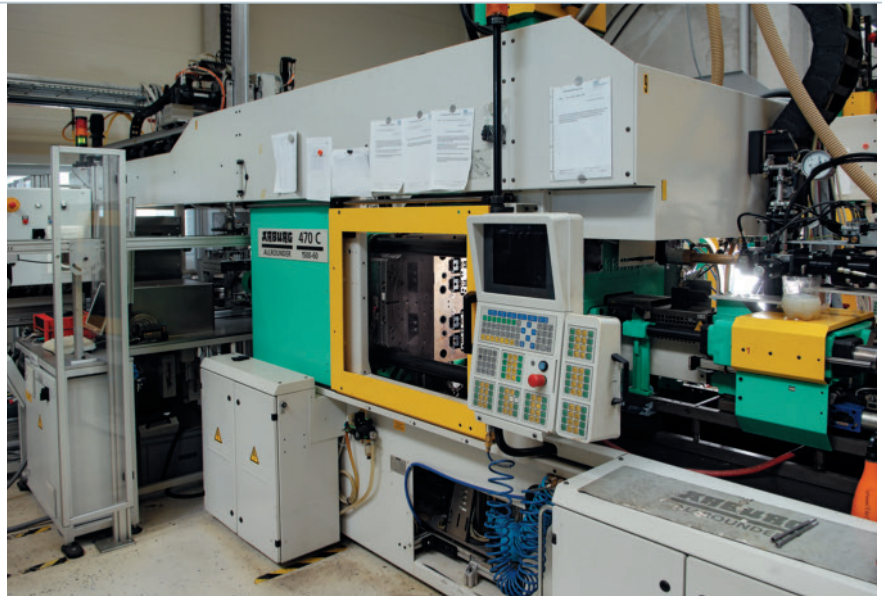
Bild 5. Ausgefeilte Integrationslösung: Ein pneumatisches Bewegungssystem fährt die Plasmadüse von unten in die Spritzgießebene der Maschine ein
