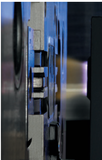
Bild 4. Blick in die Spritzgießmaschine: Mit nahezu Schallgeschwindigkeit trifft das Openair-Plasma auf die Polycarbonatlinsen. Die mikrofeine Reinigung und hohe Aktivierung verleiht dem Kunststoff neue Haftungseigenschaften
