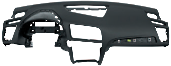
BILD 5 Eine Fräsanlage sorgt für die Instrumentenöffnungen; von den plasma-unbehandelten Bereichen kann die hinterschäumte Slushhaut leicht manuell entfernt werden
