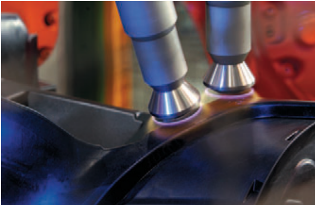
BILD 1 Das atmosphärische Openair-Plasma arbeitet ortsselektiv und bewirkt die mikrofeine Reinigung und hohe Aktivierung der Polypropylen-Oberfläche der Instrumententafel
