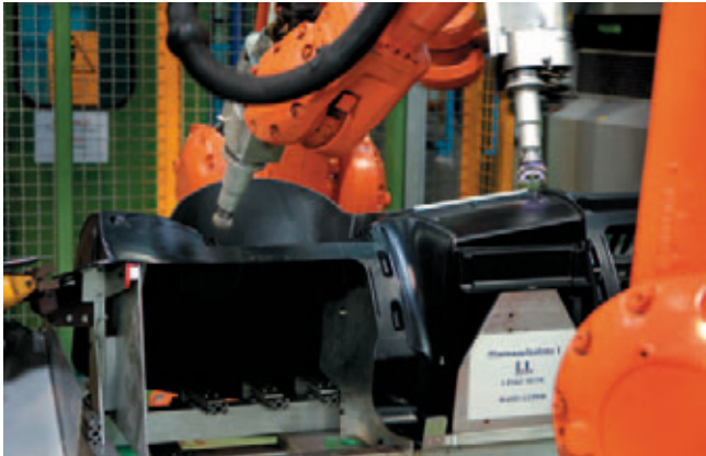
BILD 3 Die an zwei Roboterarmen montierten Plasmadüsen fahren konturgenau die Oberfläche ab und sparen dabei exakt die Bereiche aus, an denen keine PUR-Schaumhaftung erfolgen soll
