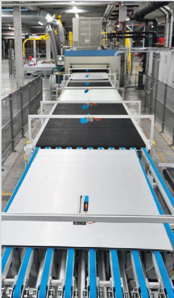
◀ **Bild 9:** In einem voll automatischen Produktionsprozess werden die stahlbeschichteten Honeycomb-PP-Paneele bei Elytra gefertigt.
