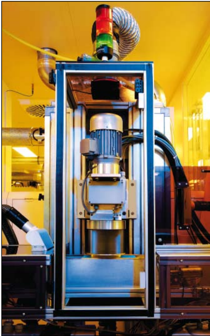
Bild 4: Die Leiterplatten laufen im kontinuierlichen Prozess von der Bestückung durch das Plasmasystem bis in die Siebdruckanlage. Die raumsparende Plasmaanlage bedient bei Novotechnik vier Siebdrucklinien
