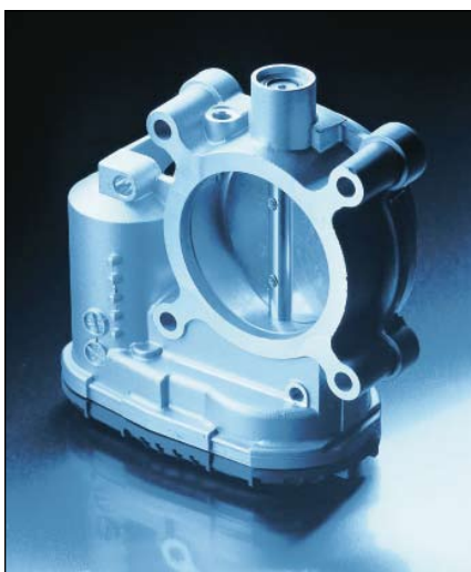
Bild 5: Komplette Drosselklappeneinheit mit Klappe, integriertem Stellmotor und Sensor. Die Vorbehandlung mit Open Air Plasma erfolgt bei der Beschichtung der integrierten Sensorleiterplatte
