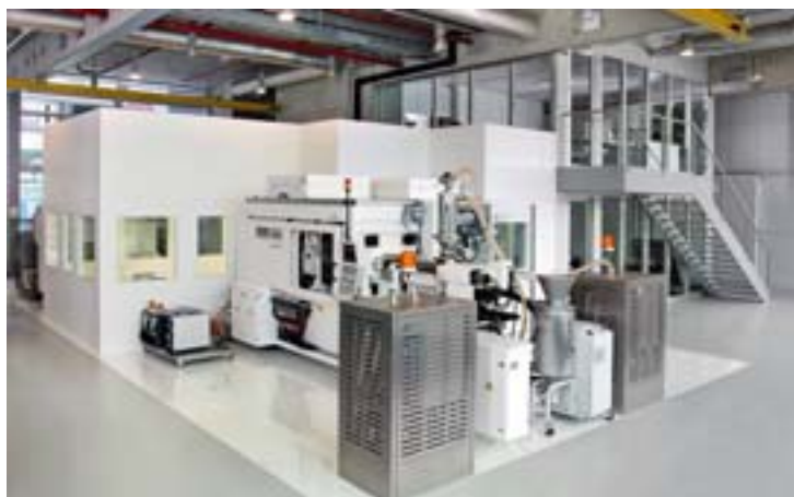
Fertigung im Reinraum von Gira: Zusätzliche Filter und Laminatflow-Module über dem Handling und Werkzeugbereich der von außen ange bundenen Spritzgießmaschine sorgen für eine gleich bleibende Luftqualität während der gesamten Fertigung
