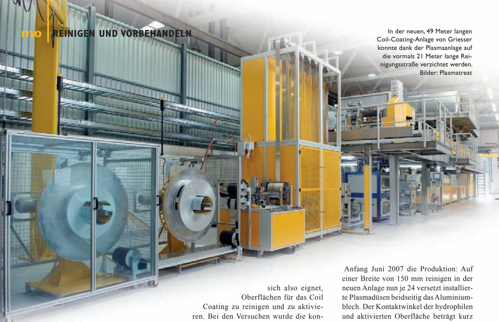
führte die Prüfung der von Plasmatreteat entwickelten Systeme für die Reinigung und Aufbereitung der Aluminiumbahnen bei Griesser aus.
