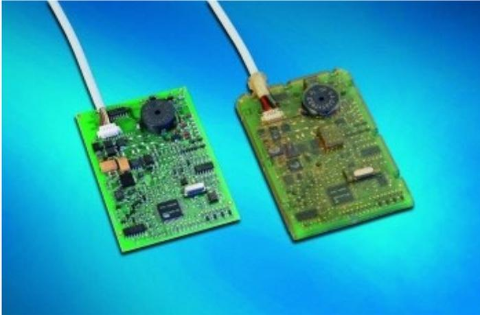
Vor dem Umspritzen mit Hotmelt werden die Baugruppen mit dem Atmosphärendruck-Plasma vollflächig vorbehandelt (links). Die anschließende Versiegelung mit Hotmelt schützt die Leiterplatte vor Feuchtigkeit und mechanischer Beschädigung
