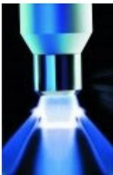
Ein Merkmal des Openair-Prozesses: der austretende Plasmastrahl ist elektrisch neutral, wodurch sich die Anwendung stark erweitert und vereinfacht. Seine Intensität ist so hoch, dass Bearbeitungsgeschwindigkeiten von mehreren 100m/min möglich sind. Die typischen Erwärmungen von z.B. Kunststoffoberflächen betragen während der Behandlung weniger als 20°C.
