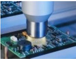
Beim patentierten Openair-Verfahren von Plasmatreteat in Westfalen werden Oberflächen mit atmosphärischem Plasma behandelt. Das mit speziellen Düsen aufgetragene Plasma, reinigt und aktiviert die Oberflächen, ohne dass die Baugruppen mit elektrischer Spannung in Berührung kommen. Das Ergebnis: Lacke, Farben, Klebstoffe oder Vergussmassen haften optimal.
