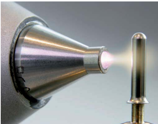
Mikrofeine Vorreinigung und Aktivierung in der Spritzgusstechnik: Der Metallstift wird anschließend mit Kunststoff umspritzt.
