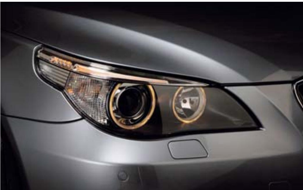
Die Vorbehandlung mit Openair-Plasma sorgt beim Einbau von Scheinwerfern für eine feste, diffusionsdichte Verklebung und für eine sichere Abdichtung gegen das Eindringen von Feuchtigkeit. Bilder: Plasmatreteat
