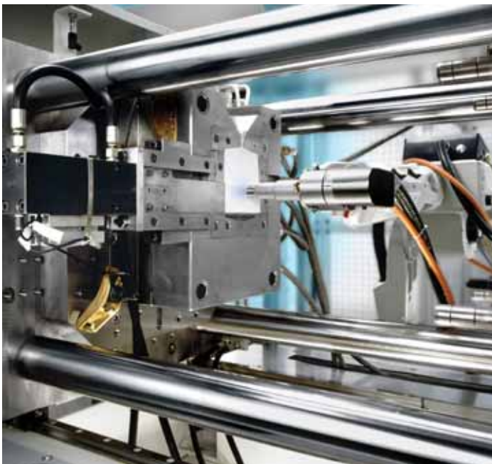
图 5 在双组分注塑成型中，汽车部件的基层材料首先采用注塑成型，然后使用 Openair 等离子技术进行界面处理，再立即二次注塑成型柔性材料（图片来源于 Krauss-Maffei 公司）
