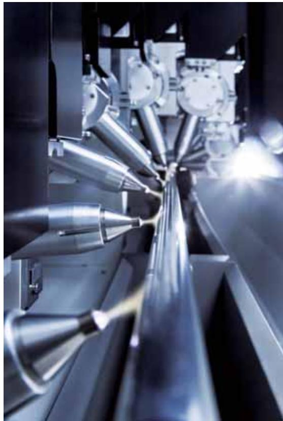
图5 EPDM密封生产商 Hutchinson 自 20 世纪 90 年代末就已为使用水性涂料而从底漆切换成常压等离子（图片来自 Plasmatreat）
