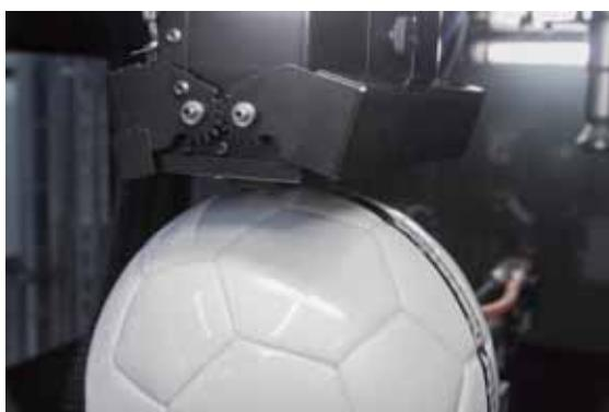
图 4 等离子预处理后立即在 4 色紫外数码喷墨印刷工艺中按需应用喷墨（图片来自 Heidelberger Druckmaschinen 公司）
