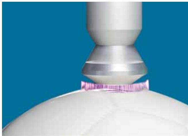
图 6 在以 2 700 r/min 的最高转速运行时，发射出的常压等离子变得肉眼不可见，只有紫色光弧是可见的。喷枪的旋转能力确保了对塑料的均匀预处理和完全润湿（图片来自 Heidelberger Druckmaschinen 公司）
