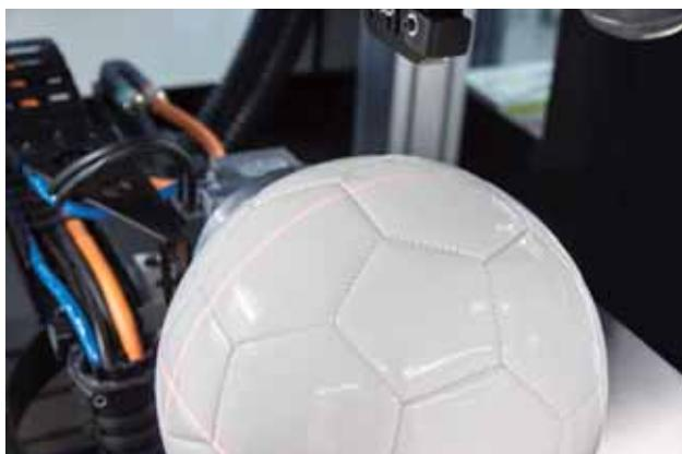
图 2 激光超声传感器测量由吸盘吸持的物体，并将数据发送给四轴机器人控制器，以为后续的等离子预处理确定物体确切的起始位置（图片来自 Heidelberger Druckmaschinen 公司）
