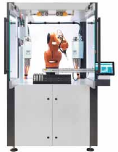
图6 交钥匙的、完全自动化的 PTU1200 等离子工作站包含了这项等离子工艺所需的一切硬件设备,能够被连接到任何传统的注塑机上(图片来自 Plasmatrete)
