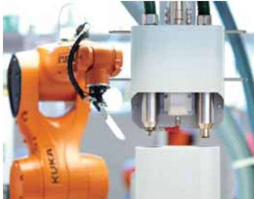
图 7 Plasmatrear 的 PST 系统拥有两个单独的等离子喷枪。首先，金属嵌件在 Openair 等离子束下以分子水平而得到清洁，然后立即通过第二个等离子喷枪施加 PST 功能镀膜 (图片来自 Plasmatrear)
