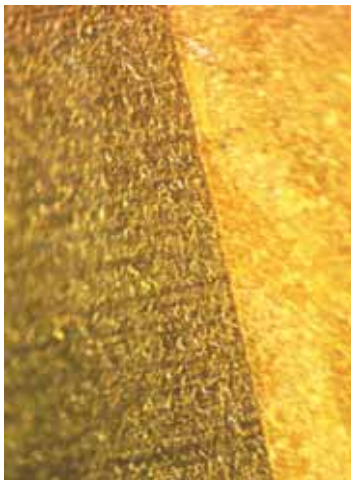
图5 该显微图片显示了有等离子镀膜、无腐蚀的金属表面与未镀膜的腐蚀区域之间有着明显的区别(图片来自 Plasmatrete)
