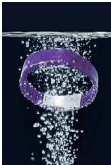
图1 随着使用时间的延长，腐蚀性介质可能会穿过塑料与金属之间的界面并渗入部件，引起破坏甚至分层（图片来自 Plasmatreat）
