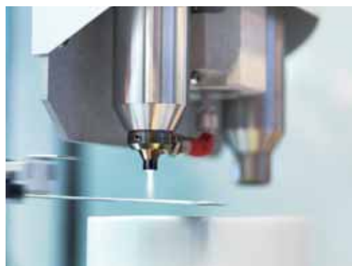
图 2 具备化学-物理作用的 Plasma-SealTight 工艺，能够在毫秒内在表面沉积功能性的纳米涂层，且沉积区域是可选的，从而在不同的材料之间创建了共价键（图片来自 Plasmatreat）
