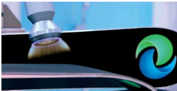
图7 Openair 和 PlasmaPlus 等离子处理技术使得比赛滑雪板的超高分子量聚乙烯基板得到了改变和功能化，从而使可吸附的蜡量增加了6倍（图片来自 Environment Park）
