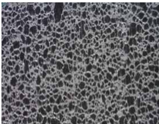
图5 得到处理前的滑雪基板的烧结超高分子量聚乙烯结构，其微孔中已经堆积了堵塞物和灰尘（图片来自 Scuola Skiman）
