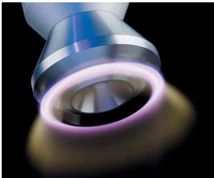
图 3 Openair 等离子处理技术只需一步即可完成对材料表面的精细清洁与活化 (图片来自 Plasmatreteat 公司)
