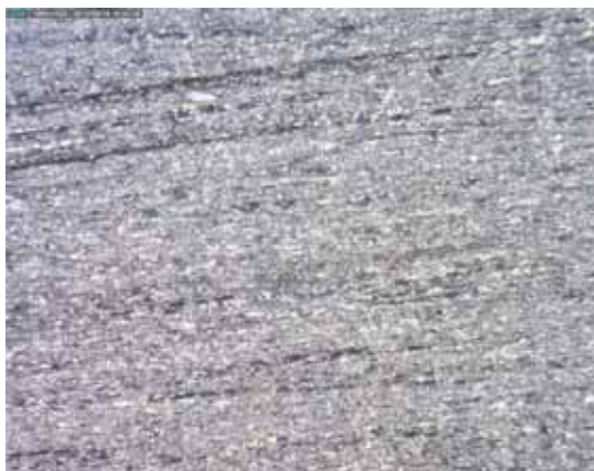
图4 在三维蜂窝结构中的微孔已经塌陷：此时，不再可能进行上蜡（图片来自 Scuola Skiman）
