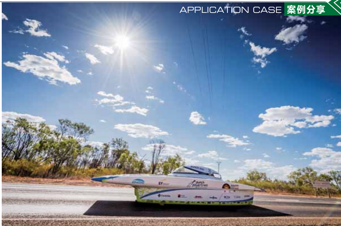
图 1 仅由太阳能驱动：这辆高效率的 Punch One 太阳能汽车，参加了在澳大利亚举行的世界太阳能车挑战赛。等离子粘接工艺使 CFRP 车身重量减轻了几公斤（图片来自 Punch Powertrain 太阳能车队）
