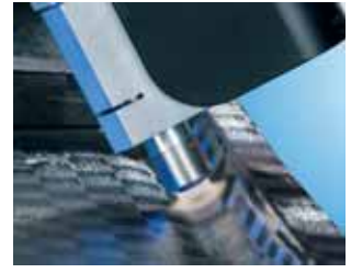
图 9 采用 Openair 等离子旋转喷枪对 CFRP 表面预处理，同时实现了对塑料表面的微细清洁、静电中和与强力活化，从而显著提高了塑料表面的润湿性和粘附能力（图片来自 Plasmamatreat 公司）
