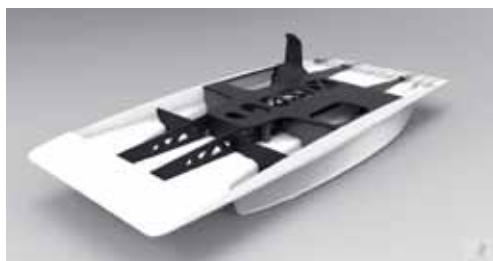
图 2 等离子处理的单体底壳展示出肋骨和抗扭箱体（图片来自 Punch Powertrain 太阳能车队）
