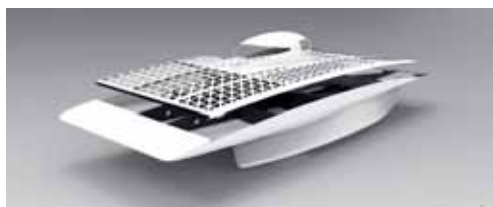
图 4 不同车身层次的组合（图片来自 Punch Powertrain 太阳能车队）
