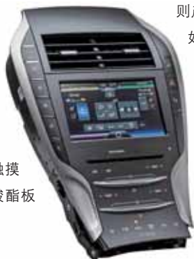
图 2 该“中央操控区”位于中央控制台的中心，并将各种功能融入到这一紧凑区域中。下半部分包括一个拥有印刷电路的敏感的触摸膜（图片来自 Preh 公司）
