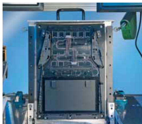
图 4 整个 PET 触摸膜涂有背胶，被无气泡地粘接到等离子活化的塑料外壳上（图片来自 Plasmatreat）
