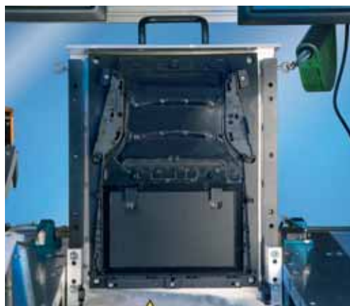
图 3 该聚碳酸酯板在等离子处理后立即被放入层合机中（图片来自 Plasmatreat）
