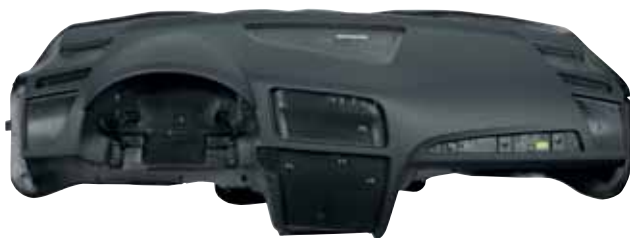
图 4 采用等离子预处理后的仪表盘。搪塑表皮和发泡层的粘接，以及在安全气囊区域不粘接的效果（图片来自 Plasmatreat 公司）
