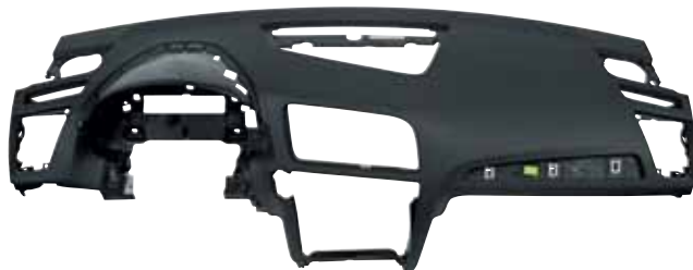
图 5 一种磨削系统为仪表板的开孔而准备。这种背部发泡的搪塑表皮能够由手工轻易地将其从未作等离子处理的区域去除掉（图片来自 Plasmatreat 公司）
