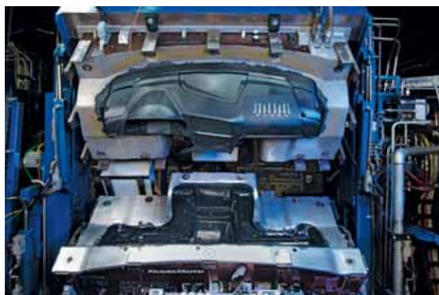
图 3 当开启时，这种发泡装置就像一个巨大的三明治烤箱。PUR 泡沫将被施加到搪塑表皮（底部）的上面。在闭合该发泡装置后，泡沫在 PP 板（顶部）和表皮之间均等地分散开，并将二者粘接起来（图片来自 Plasmatreat 公司）
