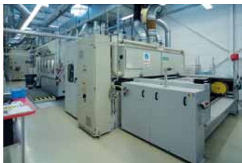
Openair 等离子系统（从前数第三个单元）在 25 m 长的喷涂生产线中仅占 1 m 的空间（图片来自 Plasmatreteat）
