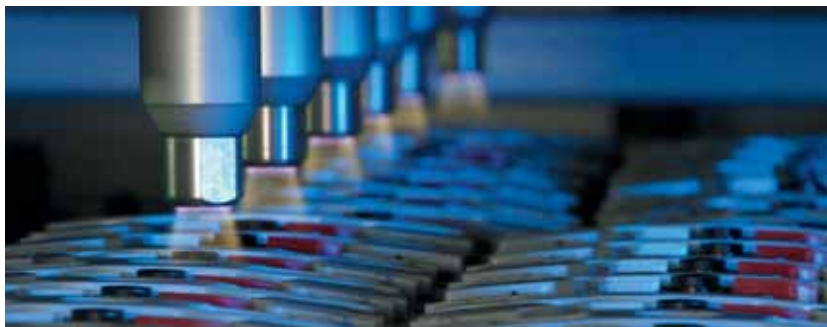
6个等离子旋转喷枪昼夜不停地在线运行，每周它们要在单一操作中清洁和活化 180 000 个 PC 和 PC/ABS 的外观部件（图片来自 Plasmatreteat）
