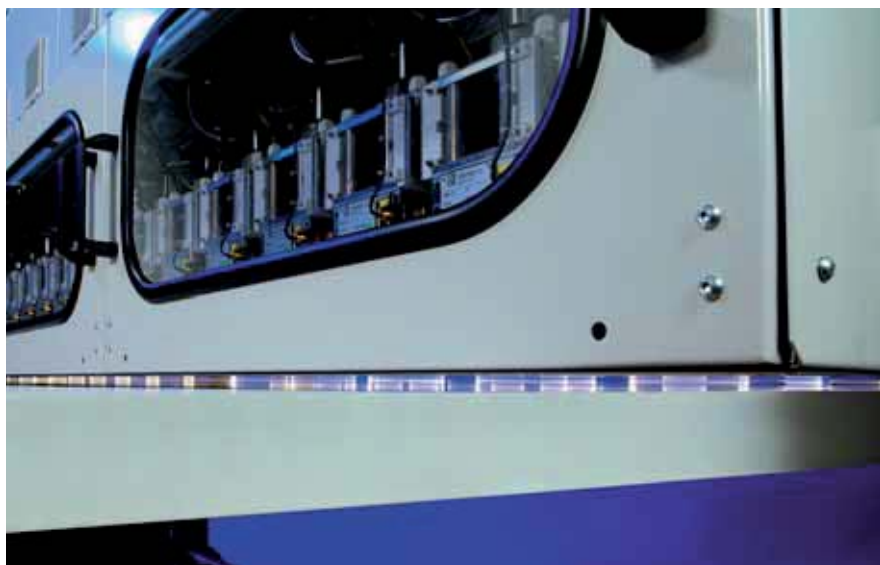
图5 用于替代底涂的一种绿色而高效的方案：28个Openair®等离子旋转喷枪中的每一个都被设计成可对100 mm宽的材料进行预处理，它们呈两排相对布置，从而使高达3 m宽的板材得到活化处理和微细清洁（图片来自Plasmatreat）
