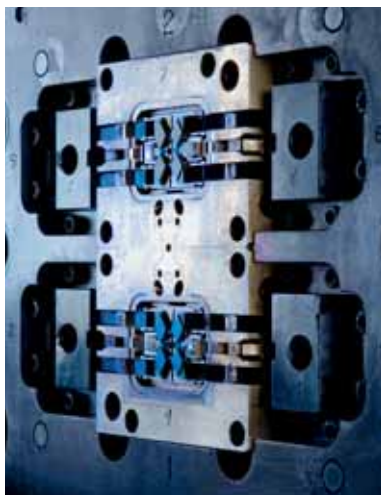
图7 在机器的上型腔中，预成型好的部件准备着接受PBT的包覆成型（图片来自 Plasmatrete）
