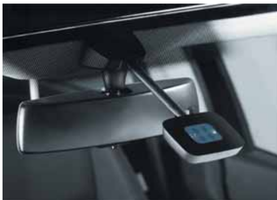
图1 这种雨水/光线传感器可反射进入的光束，同时可测量光的折射角度。透明的 LSR 形成覆盖层，用于与玻璃窗进行粘接（图片来自 Plasmatreteat）
