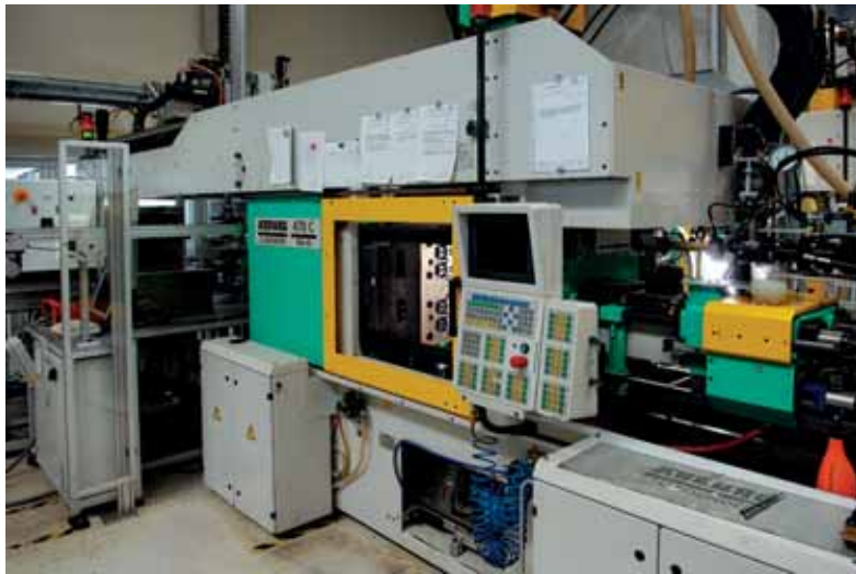
图6 完美的集成解决方案：一个风动系统移动等离子喷嘴，使其从下方进入到机器的注射成型区域（图片来自 Plasmatrete）
