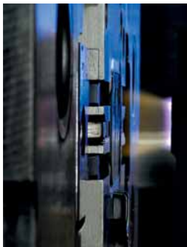
图8 Openair® 等离子束以接近超音速的速度轰击到聚碳酸酯镜片上。通过微细清洁和强力活化处理，使塑料材料获得了新的粘接性能（图片来自 Plasmatrete）
