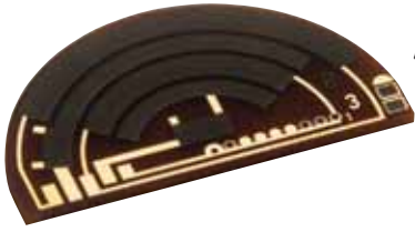
图8 这些已得到印刷处理的电路板被放在炉中进行固化处理。一旦这些电路板被分开后,就会100%地接受目测和电子检测的检查(图片来自Plasmatrete公司)
