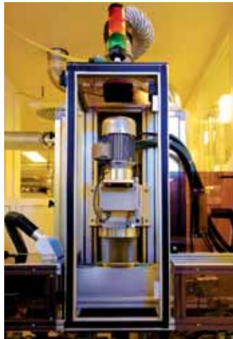
图 5 从等离子体处理系统直到丝网印刷生产线，电路板需要经历一系列连续的处理过程。Novotechnik 公司所使用的等离子体装置减少了占地面积，可同时满足 4 条丝网印刷生产线的需要（图片来自 Plasmatreteat 公司）
