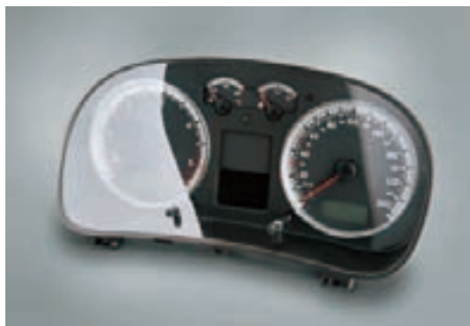
图6 仪表盘壳体注塑成型后, 在对其进行喷涂前, 需要使用常压等离子体对其进行彻底净化 (图片来自 Plasmateat 公司)
