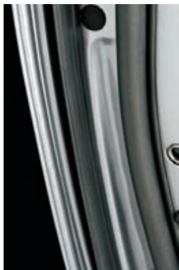
图5 对门封条的Openair ® 等离子预处理替代了粘接前无溶剂底涂的应用(图片来自Plasmatreteat公司)
