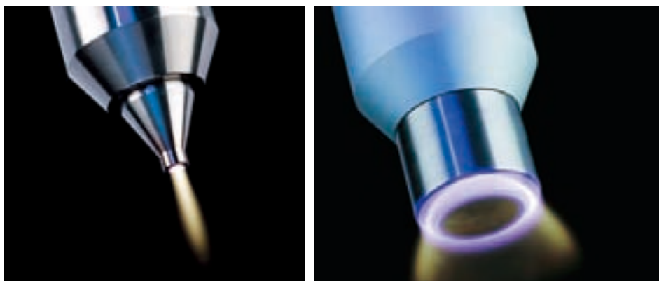
图2和图3 根据对材料的处理速度和距离的不同,可实现不同的表面活化效果。这些射出角度相对较小的喷枪适合于处理狭小断面和复杂的表面形状,而可旋转的喷枪所处理的表面可达到40mm宽。对于相对较大的预处理表面,可同时使用几个喷枪(图片来自Plasmatreteat公司)
