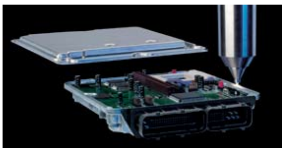
在涂布粘结剂之前，利用常压等离子体“Openair-Plasma”对壳体接合面进行预处理和活化，使得电子器件的封装实现最佳的气密性（图片来源：Plasmatreteat 公司）
