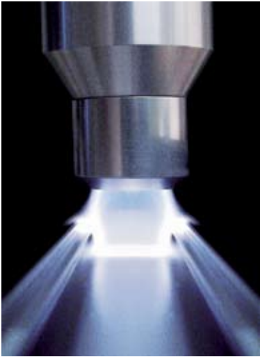
电中性的常压等离子体“Openair-Plasma”能够对表面进行深度的净化处理，使其高度活化，并可在表面形成极薄的涂层（图片来源：Plasmatreteat 公司）
